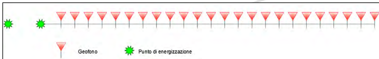
Figura 3 - Rappresentazione schematica di array per acquisizione di MASW su stesa PS4
