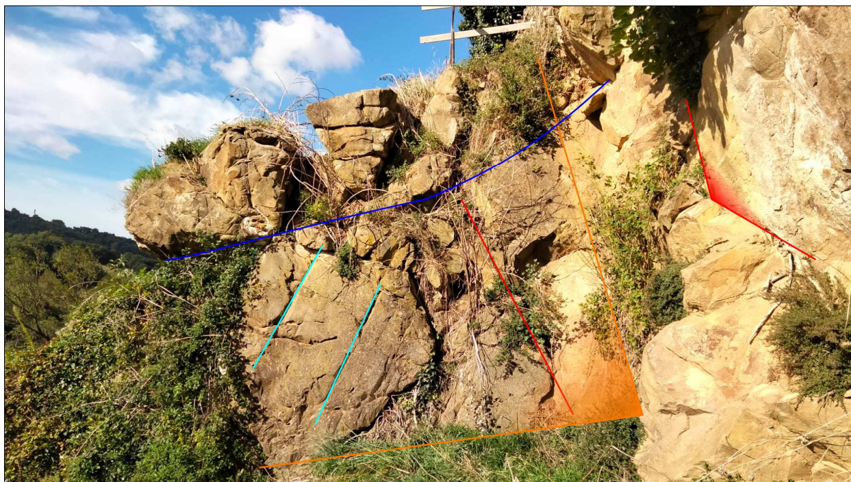
Figura 11 - Scatto del 22/01/24 della parete rocciosa con individuazione della stratificazione (S0 in blu) e delle famiglie di discontinuità (F1 in rosso - F2 in ciano - F3 in arancione)
