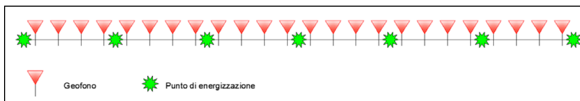
Figura 6 - Rappresentazione schematica di array sismico a rifrazione
