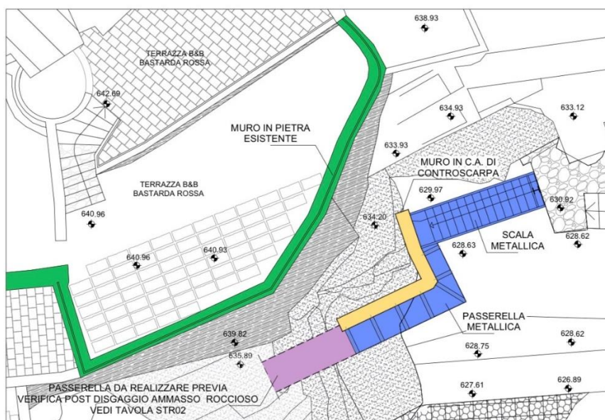
Fig.61 Zona 5 Sviluppo planimetrico della passerella sospesa
